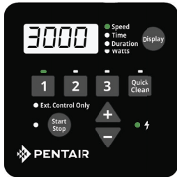
Abbildung 8: Festlegen der Drehzahl
