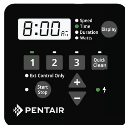
Figura 9: impostazione dell'orario di avvio
