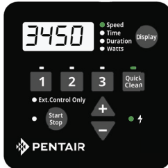
Figuur 12: snelheid instellen voor Quick Clean
