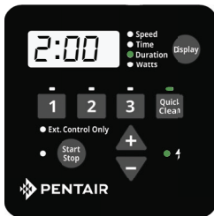
Figuur 13: cyclustijd instellen voor Quick Clean
