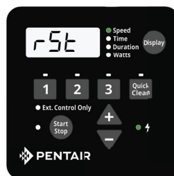
Figure 14 : Réinitialisation du périphérique
