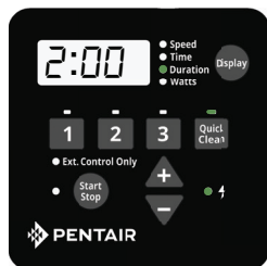
Figura 13: impostazione della durata di QuickClean
