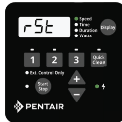
Figura 14: Restablecimiento de la unidad a sus valores de fábrica
