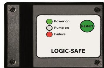
Para restablecer el funcionamiento normal del aparato y de la instalación, pulse la tecla "Restart".
