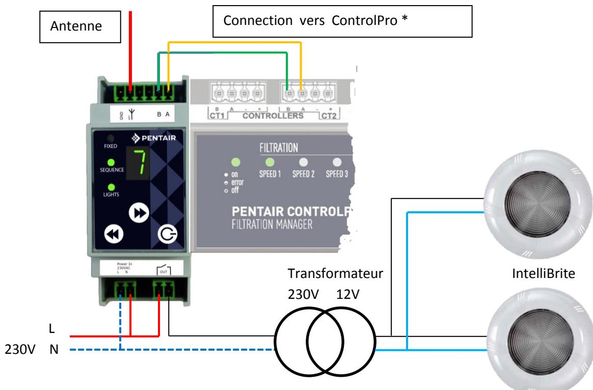
La plupart du temps, l'antenne fournie avec le système est suffisante. Cependant, il est possible de connecter une antenne externe pour améliorer les performances de la télécommande. Dans ce cas, raccordez l'âme du câble à la sortie ANT et le blindage métallique à GND.
