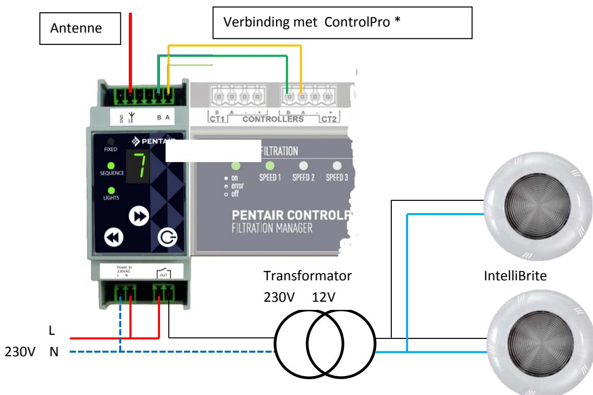
In de meeste gevallen volstaat de meegeleverde antenne. Als de verbinding met de afstandsbediening onvoldoende is kan een externe antenne aangesloten worden. Kern van de antennendraad op ANT, de metalen bescherming op GND
