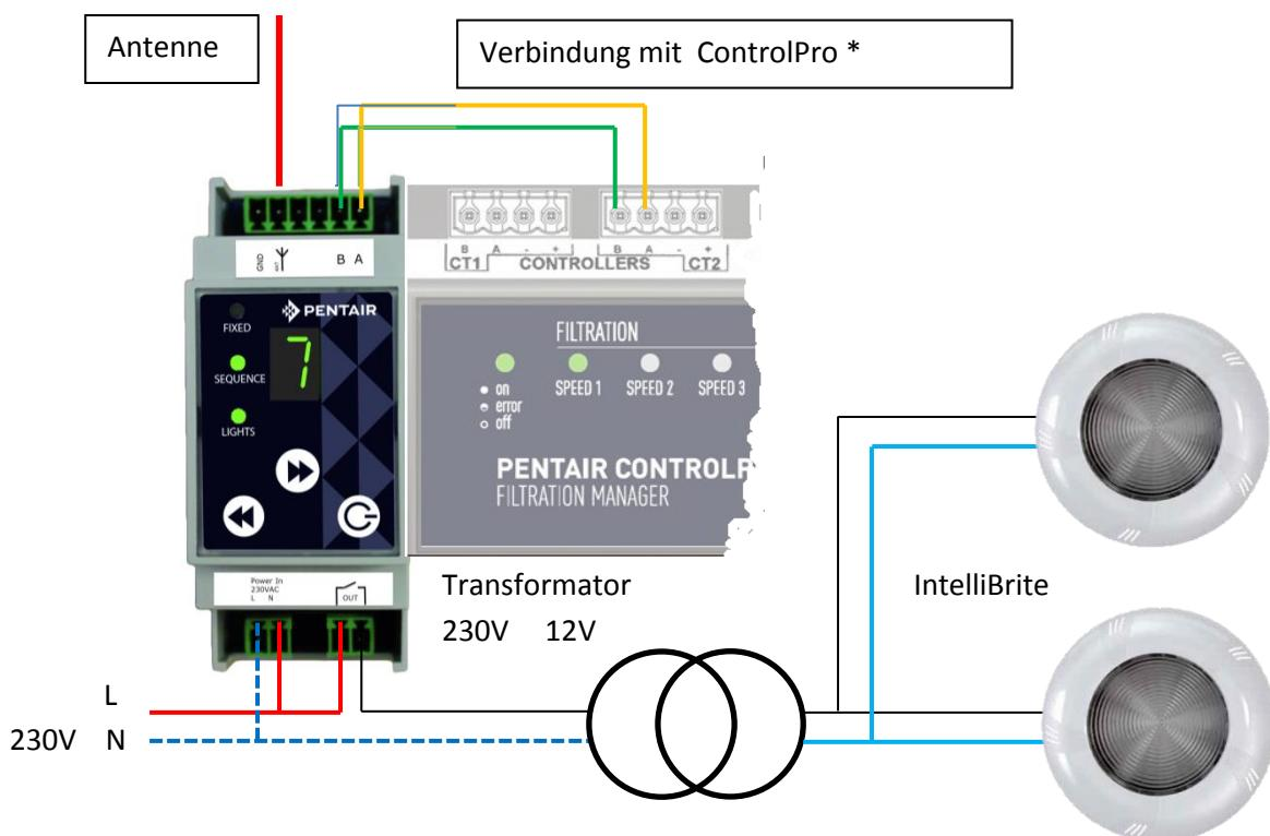
Die mitgelieferte Antenne ist in den meisten Fällen ausreichend. Sie können jedoch eine externe Antenne anschließen, um die Leistung der Fernsteuerung zu verbessern. Verbinden Sie in diesem Fall den Kabelkern mit ANT (Antenne) und die Metallabschirmung mit GND (Erde).
