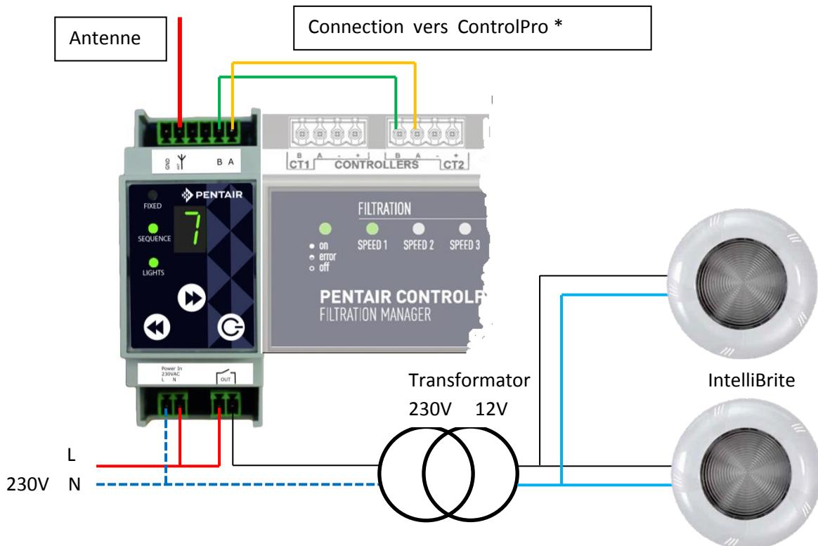
Nella maggior parte dei casi, l'antenna fornita con l'impianto è sufficiente. Tuttavia, è possibile collegare un'antenna esterna per aumentare le prestazioni del telecomando. In tal caso, collegare il nucleo del cavo ad ANT e la schermatura metallica a GND.
