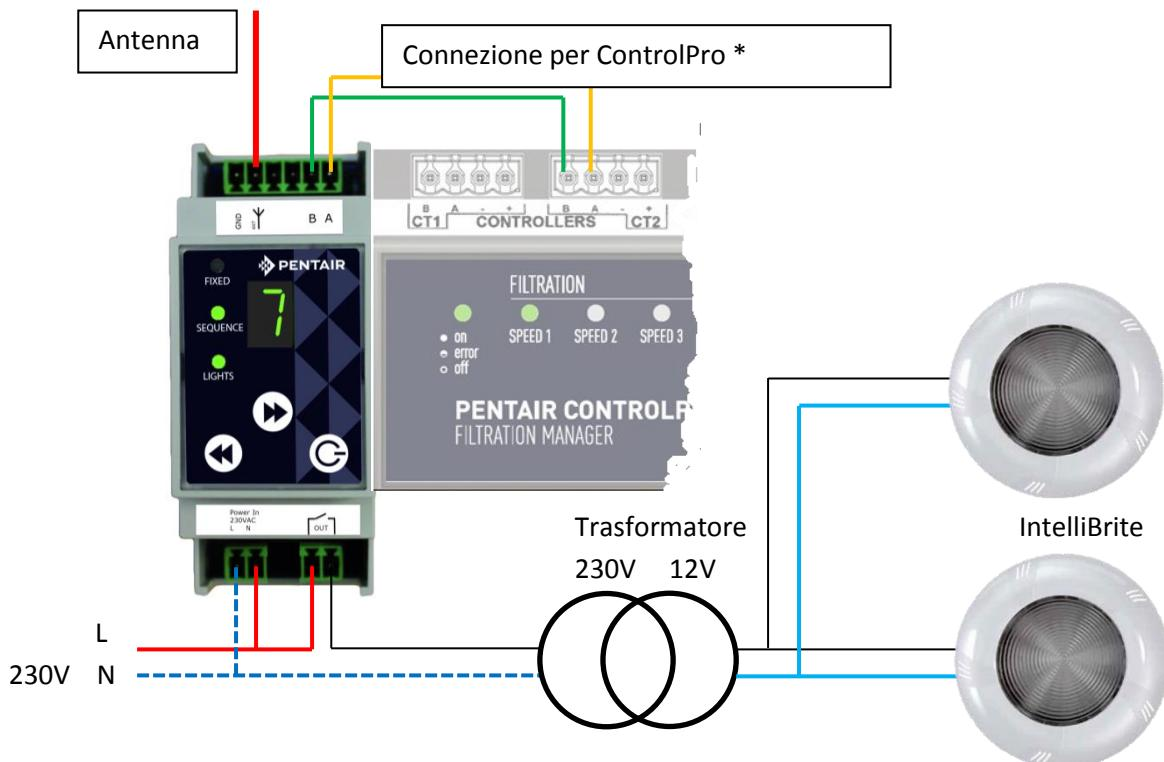
En la mayoría de los casos, es suficiente con la antena incluida con el sistema. No obstante, es posible conectar una antena externa para aumentar el rendimiento del mando a distancia. En tal caso, conecte el núcleo del cable a ANT y el blindaje metálico a GND.
