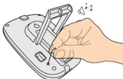
1. Placer l'interrupteur sur le mode alarme (face arrière de l'afficheur d'intérieur).
