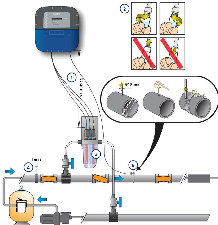
**1** Les câbles des sondes ne doivent pas croiser le câble d'alimentation (risque d'interférences), ni être enroulés sur eux-mêmes.
