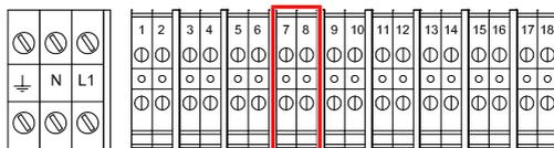
La consommation électrique du volet automatique de la piscine ne doit pas excéder 16 A en mono-phasé.
