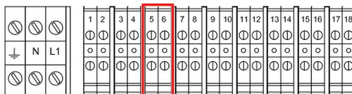
Le raccordement du câble de pilotage devra être effectué sur les borniers Bus + et - de l'INTELLIPOOL (Contrôle Center ou Probe Unit).
