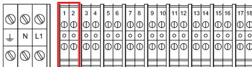
Dans le cas de l'utilisation d'un électrolyseur d'autre marque, vous pouvez utiliser le pilotage par contacts secs au moyen des bornes 13 et 14.
