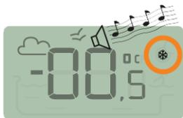
Le pictogramme gel lié à la température de l'air s'affiche si la température mesurée par le relais radio est inférieure à +3°C.
