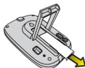
2. Retirer le film isolant des piles.
