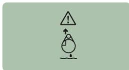
Les sondes pH et RedOx (ORP) doivent toujours tremper dans l'eau pour éviter leurs assèchements.
