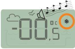
Das Gefrierpiktogramm für die Lufttemperatur wird angezeigt, wenn die vom Funkrelais gemessene Temperatur unter +3°C liegt.
