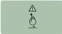
PH- und RedOx-Sonden (ORPs) sollten immer in Wasser getaucht werden, um ein Austrocknen zu verhindern.
