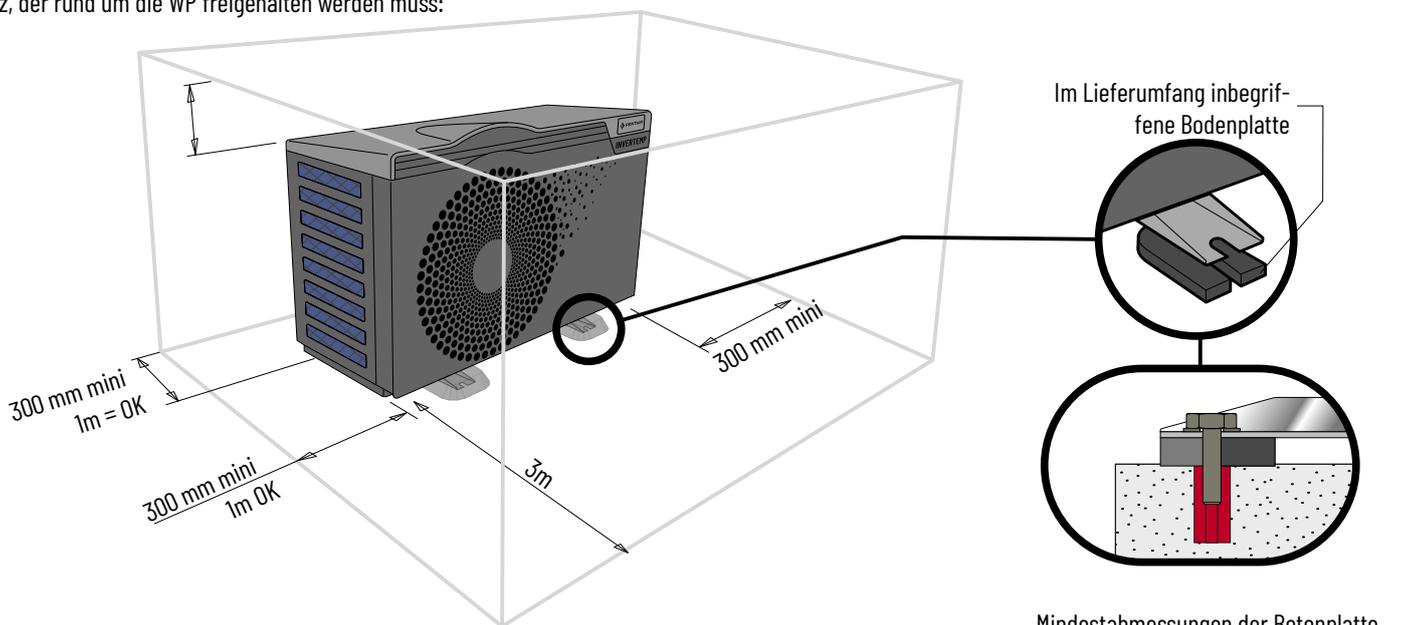
Die WP muss fix auf einem starren, festen Sockel installiert werden, wobei die mitgelieferten Bodenplatten unter den Füßen positioniert werden müssen.
