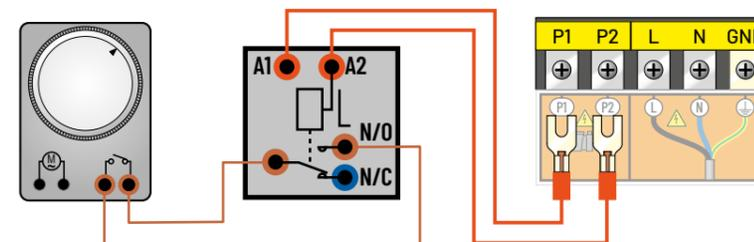
Paramètre pour la prise en compte du branchement : Vérifier que le réglage du paramètre de pompe de filtration (paramètre #9) soit bien réglé à « 1 ». Dans le cas contraire, nous contacter pour modifier ce réglage.
