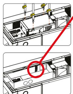
3 : Connecter au choix l'interrupteur (IN en ON-OFF) ou le RS-485
