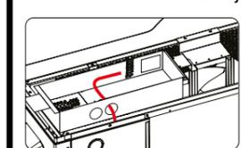
Entrée contact sec (ON-OFF déporté), retirer le shunt présent
