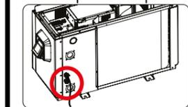
5 : Passer le câble dans le perçage latéral, suivre le chemin de câble jusqu'au bornier.
