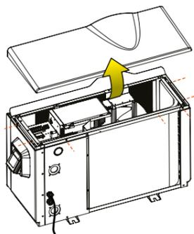
2 : Ouvrir le dessus de la boîte de connexion en dévissant les 4 vis :
