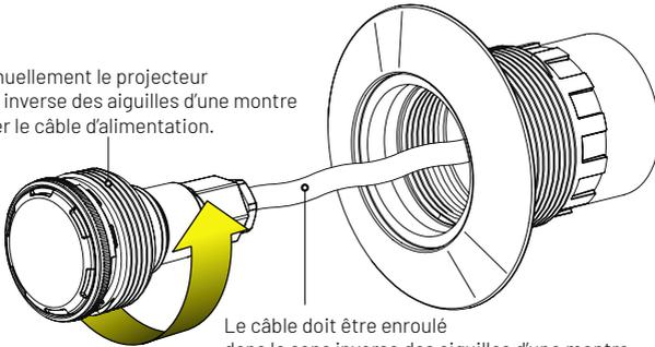
Insérez le projecteur MicroBrite dans la prise balai puis tournez manuellement le projecteur dans le sens des aiguilles d'une montre
