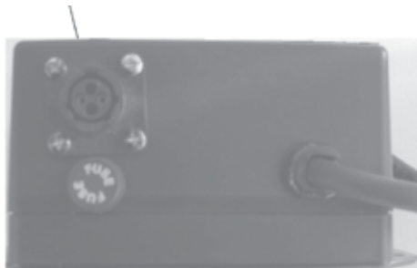
Alimentazione elettrica IC15
