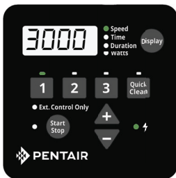
Abbildung 8: Festlegen der Drehzahl
