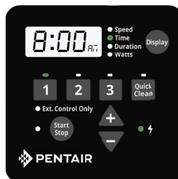
Figura 9: impostazione dell'orario di avvio
