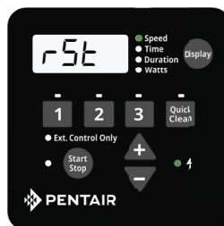
Figure 14 : Réinitialisation du périphérique
